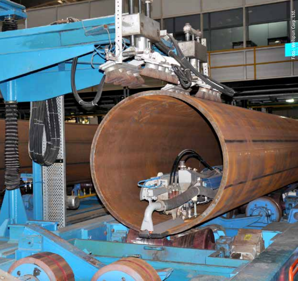
Welspun utiliza la soldadura por arco sumergido (SAW) – un proceso de soldadura que puede ofrecer altas tasas de deposición y penetración profunda a un ritmo muy rápido. Aquí, el interior de SAW de Welspun.
