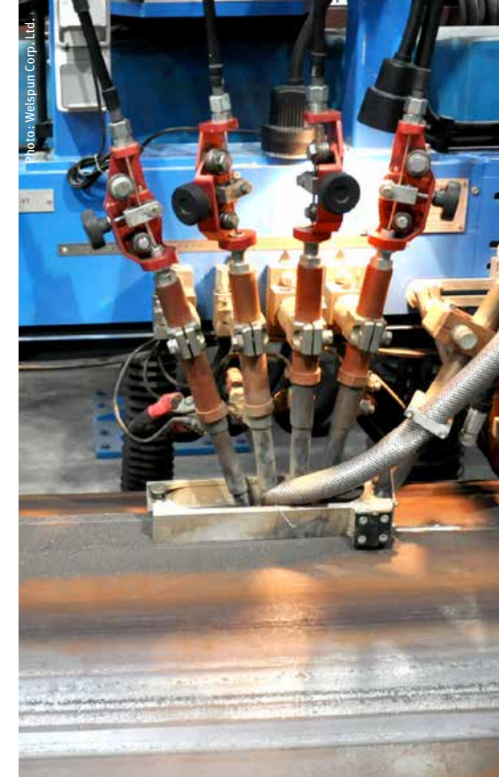
Les avancées technologiques ont permis de stimuler la performance du procédé SAW, et d'atteindre des objectifs de productivité élevés. Vue extérieure du procédé SAW de Welspun.
