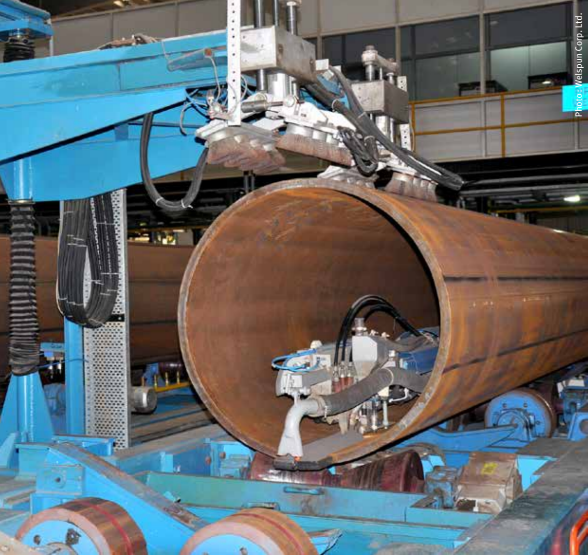
Welspun utilise le procédé de soudage à l'arc submergé (SAW) qui permet d'augmenter rapidement les taux de dépôt et la profondeur de pénétration de soudage. Vue intérieure du procédé SAW de Welspun.
